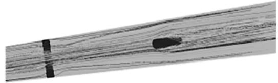
图 2 流体流过折流杆的迹线( $Re=16000$ )
