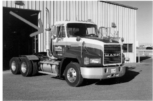
图10 装配了温差发电机的柴油机车可提高汽车动力2000~4000 W
