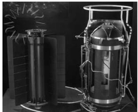
图 2 美国 NASA 研制的用于宇宙飞船上的放射性同位素温差发电系统的外形图
