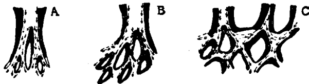
图 1 几种三角洲河口的喷流机理
