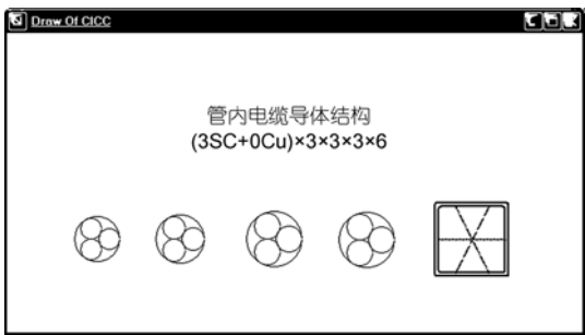
图 1 数值仿真得到的 CICC 导体结构
