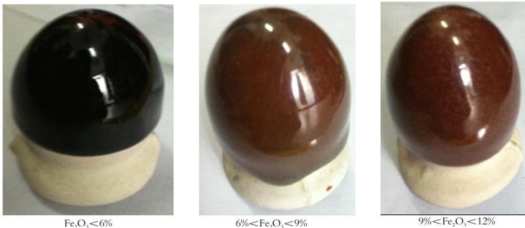
图2 Fe<sub>2</sub>O<sub>3</sub>对红油滴天目釉釉面效果的影响
