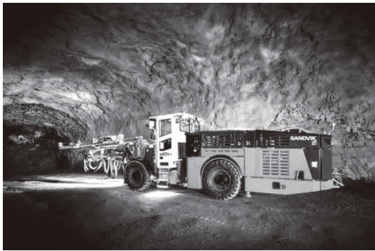
图 1 DD422iE 智能凿岩台车
