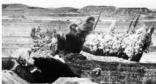
图4 黑岱沟露天矿抛掷爆破
