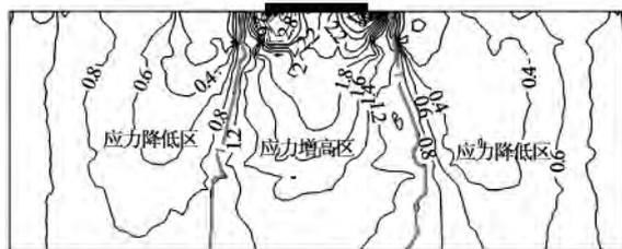
图1 煤柱底板应力分布
