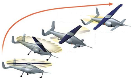
图1 旋转机翼式VTOL模态转换飞行过程
