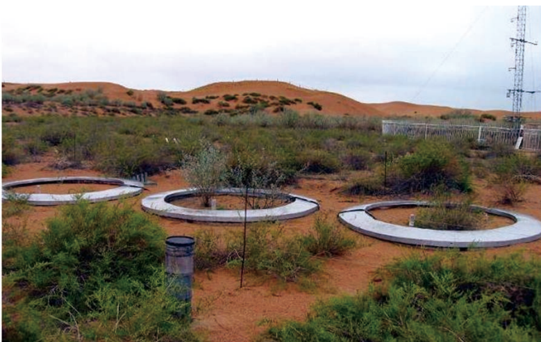
图2 利用大型称重式 Lysimeter 研究干旱沙区土壤水循环的植被调控机理
