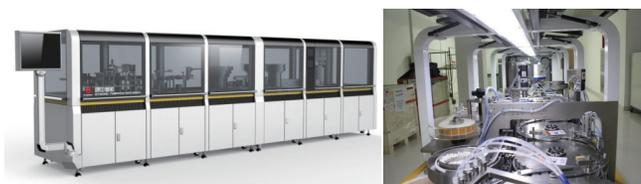
图4 行业新型烟草制品装备工程研究中心研发的电子烟烟弹组装一体机
