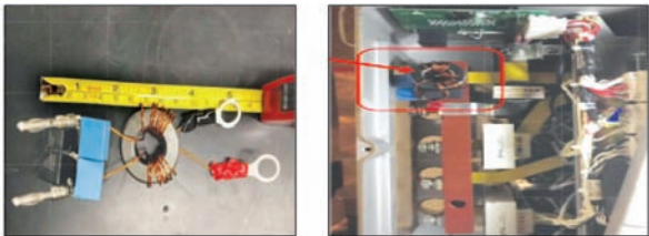
(a) EMI 滤波器实物 (b) EMI 滤波器安装位置 图 27 EMI 滤波器安装示意图 Fig. 27 EMI filter installation diagram
