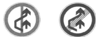
图1 禁止超车和解除禁止超车标志(国标)
