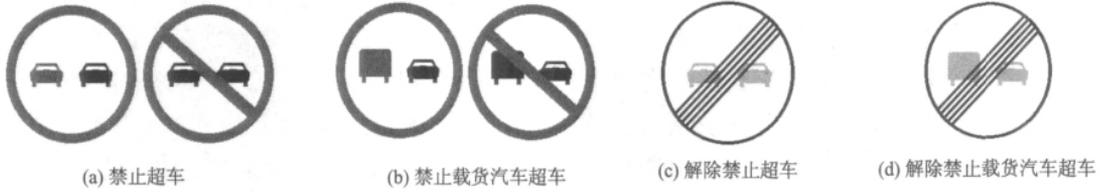
图 2 禁止超车和解除禁止超车标志 (联合国公约)
