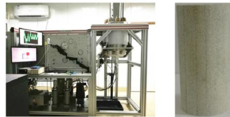
图 3 岩石全应力多场耦合三轴试验系统 (左) 与灰砂岩岩石试样 (右)
