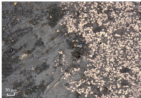
图 2 焊料金相照片
