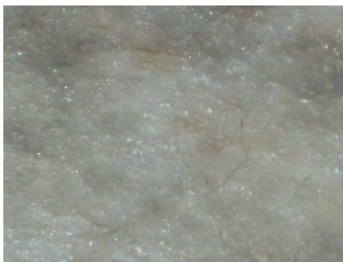
图 11 CG-TBCs 试样经 200 次热震试验后表面形貌<sup>[23]</sup>
