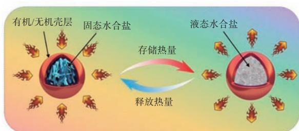
图5 无机水合盐相变微胶囊储存和释放热量过程
