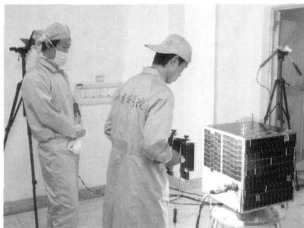
图3 伴星光照试验
