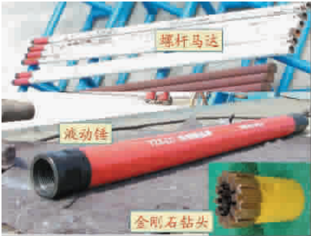
图 4 螺杆马达、液动锤和孕镶金刚石取心钻头
