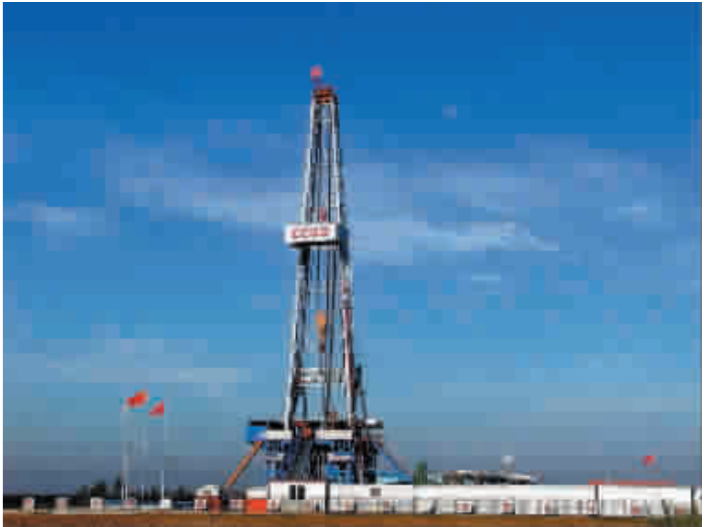
图 1 用于科钻一井施工的 7000 m 电动钻机
