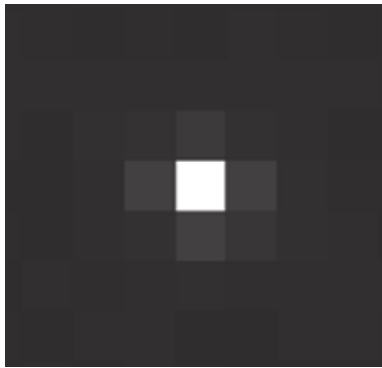
图 8 点目标信噪比测试目标点成像图 Fig.8 Output image of point target SNR test
