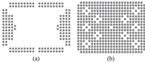
图2 焊点排布情况: (a) 基板堆叠焊点; (b) 板级互连焊点
