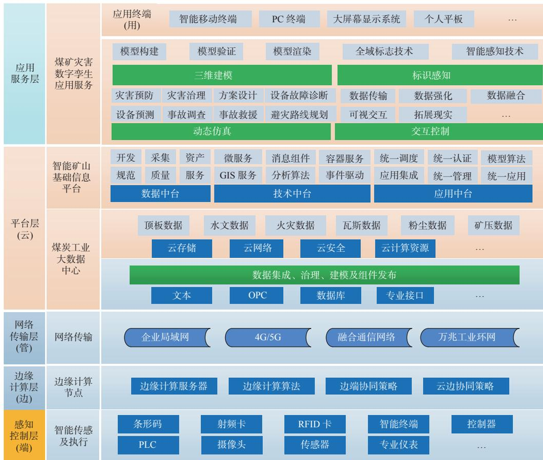
图4 基于工业互联网“云-管-边-端”架构的数字孪生服务体系
