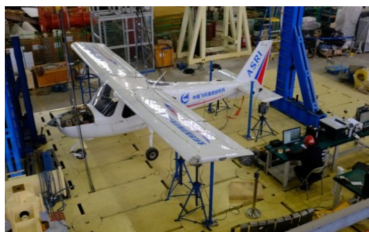
(b) 整机地面颤振试验现场
