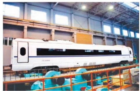
图 4 滚动振动试验台测试车辆
