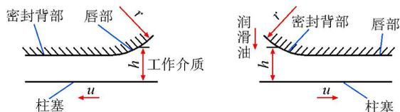
图 2 泵吸入(左)、排出(右)行程图
