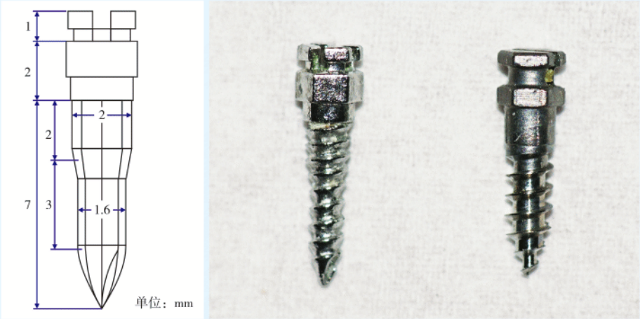
左图为新型微种植支抗钉线条图;右图左侧为新型微种植支抗钉实体图,右侧为商用微种植支抗钉实体图。
