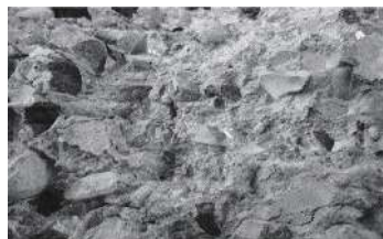
(b) 700 °C试件粗骨料破坏
