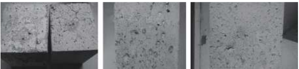
(d) 900 ℃ (e) 玻璃熔化外流 (f) 试件表面外鼓
