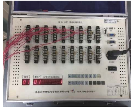
(b) CM-1L-16 型静态电阻应变仪
