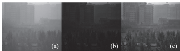
图 2 去雾与灰度映射。(a) 有雾图; (b) 偏振去雾; (c) 灰度映射
