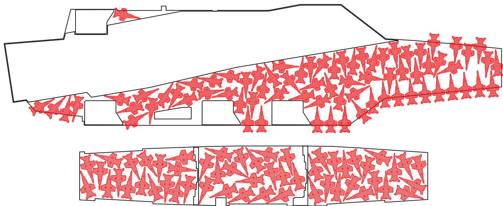
图 13 F/A-18C 飞机在飞行甲板和机库的最大布列图
