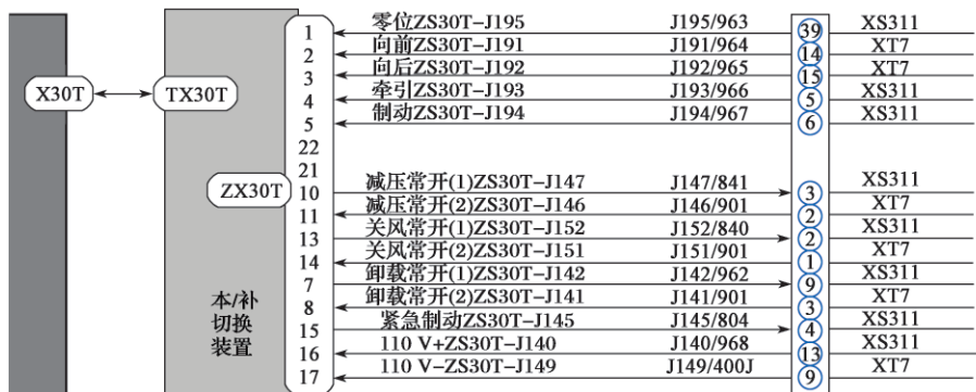
图 1 LKJ 与机车接口示意图
