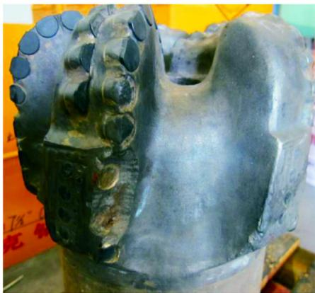
图1 出井后的常规PDC钻头照片
