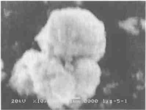
图 6 LiCoO 2 纳米粉团聚颗粒 SEM 照片
