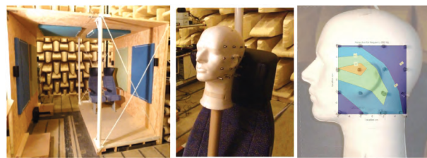
图 10 文献 [29] 中 ANC 实验平台及人工头降噪静音区
