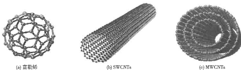
图 1 富勒烯、SWCNTs 和 MWCNTs 的单体结构示意图 Fig. 1 Monomer structures of Fullerene, SWCNTs and MWCNTs
