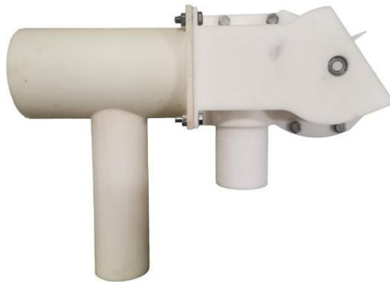
图 9 齿梳式油茶花药采集器样机
