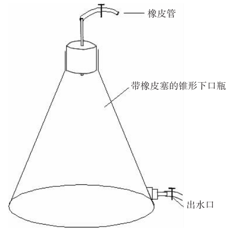
图 5 浸铀试验装置示意图 Fig. 5 Schematic diagram of uranium leaching test
