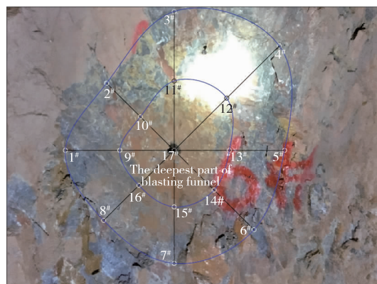
图 5 爆破漏斗体积测量特征点选取示意图
