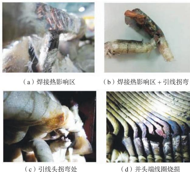
图2 牵引电机定子绕组烧损部位组图
