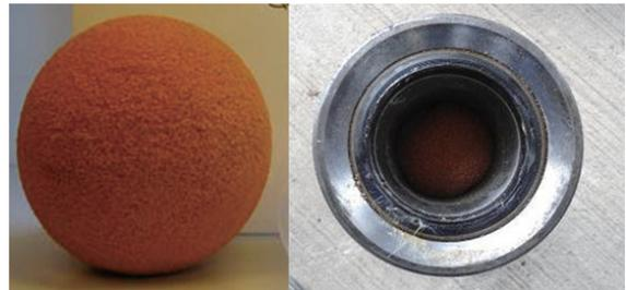
图 5 海绵球塞及其在管内压缩后的形态
