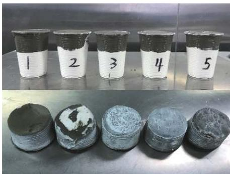
图 3 不同硅酸钠加量下水泥塞的底部状态
