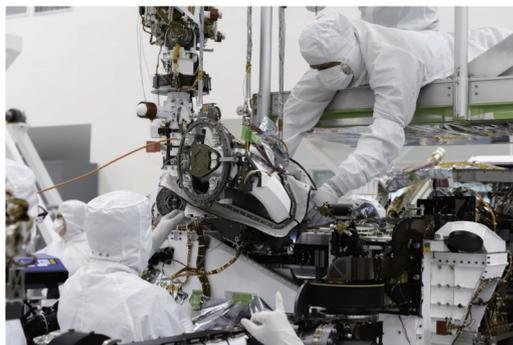
图1 身穿洁净防护服的操作人员利用辅助设施将样品管安装到“毅力号”火星车上
