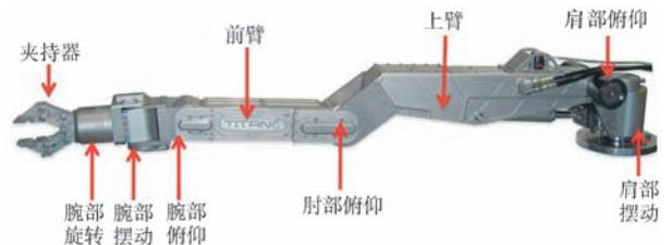
图3 Titan 4水下机械手结构组成
