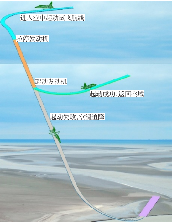
图3 空中起动试飞航线和飞行剖面
