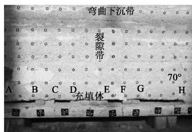
图 4 稳定状态时模型裂隙扩展图
