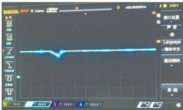
图 9 ±15 V 电源电压跌落波形
