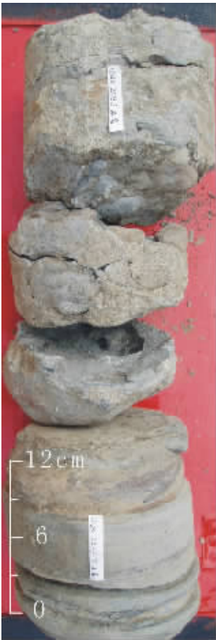
图 4 河道底部冲刷面
