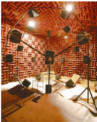
图 6 20 通道 ambisonic 三维声重发系统
