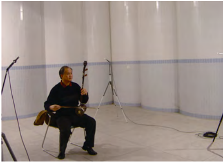
图 1 在混响室内测量乐器的声功率
