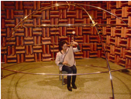
图 2 在半消声室内测量乐器的声功率
