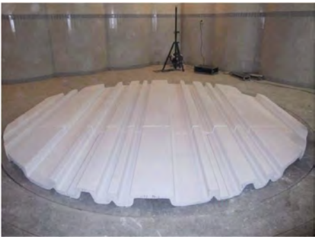
图 3 在混响室内测量扩散体散射系数
