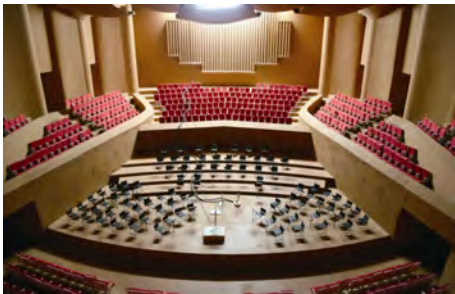
图 5 天津文化中心音乐厅声学缩尺模型
