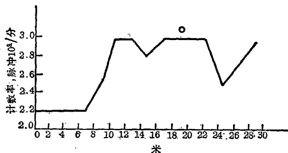
图4. 通山公社一号试验井第一测线 \gamma 曲线
