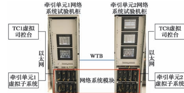
图 3 网络试验平台系统结构
