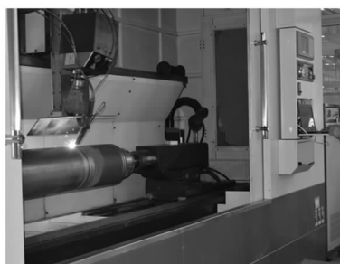
图 3 立柱外表面激光熔覆加工
