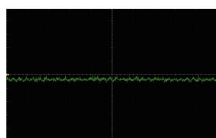
(b) 经过线性稳压电源后输出低频纹波
